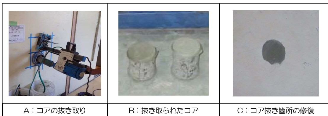
写真3-1 コアの抜き取り方法
